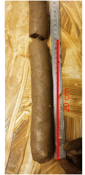
Terre 6 mur ruine Argileuse
