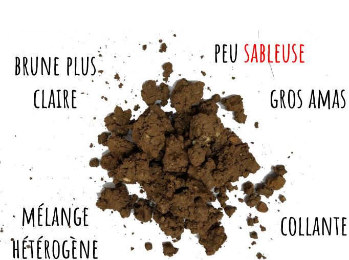
Terre 3 Provenance : Mur de refend de la remise Origine terre : inconnue
